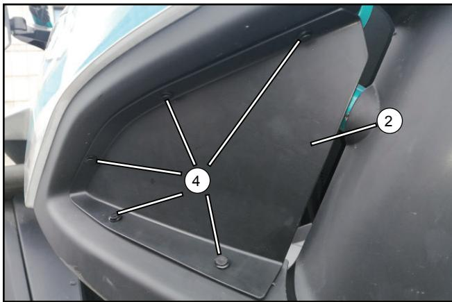
Installez le panneau d'insertion de porte droite (**2**) dans l'ouverture du panneau arrière de la porte latérale gauche et fixez-le avec des clips en plastique (**4**).
