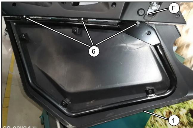
Fixez l'ensemble d'insert de porte inférieur droite (1) au cadre de porte droite (F) à l'aide des boulons (6). Serrez les fixations selon les spécifications
